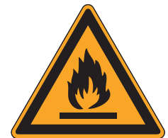
Warnung vor feuergefährlichen Stoffen
